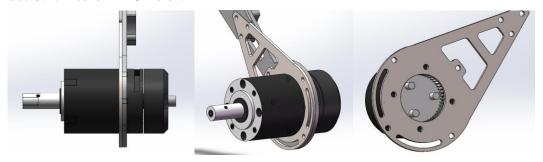
滑块底盘:全称为滑动质量块平衡步兵底盘,作用原理即在原有倒立摆的基础上添加一个可以滑动的配重块以调整质心。质量块由 6020 电机,铝铣件以及滚珠滑块构成。由 6020 驱动齿轮在齿条上进行定向运动。因为 6020 电机的质量足够,转动角度速度控制都比较精确,所以是控制滑动质量块的不二选择。
