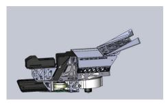
其与 pitch 轴平面形成一个夹角,在补给站补弹的时候,子弹落在弹仓盖上面,也是可以流进去,加大接弹效率和容错率,与此同时两侧的打印件设计也是为了起到一个引导作用。
