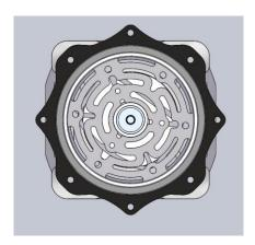
如图是 yaw 的俯视图,中间圆的碳纤维板子通过设计减重,连接 6020 电机和上面框架部分作为一个缓冲,使得框架在受到较大的冲击时能够不直接受力于电机起到保护电机的作用。此处参考了上海交通大学 2020 步兵开源。
