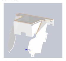
如图这个是布线部分的保护壳,采用 pc 钣金折弯技术,利用 pc 有韧性的特点可以稍微
