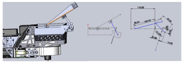
如图是弹仓盖的曲柄连杆机械设计与设计草图,设计此弹仓盖的原因是当弹仓盖开到最大的时候
