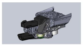
Pitch 轴的图如下,主体框架是一块 3mm 的上主板与 2mm 的下主板将枪座, Pitch 连接铣件夹在中间,上层是布线的地方以及弹仓
