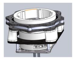
中间黑色的碳纤维板材作用是云台与底盘连接的,上面是四个利用 fusion 360 拓扑仿生 优化的打印件,下面是四根 M3D7H15 的航空六角缩杆铝柱,这样结构设计是为了让整个 yaw 轴成为一个整体,相当于将电机的定子和整个 yaw 轴连接在一起,使云台与底盘分离更容易。
