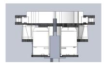
之所以是 1.8mm 左右是因为这样保证外面的板材间距是 6.4mm 左右,然后周围是用八个 M4D7H6 的 POM 隔离柱起到一个支撑作用,同时 6.4mm 的间距能够保证中间的轴承被压死,不会产生空程而导致上面的框架部分晃动。
